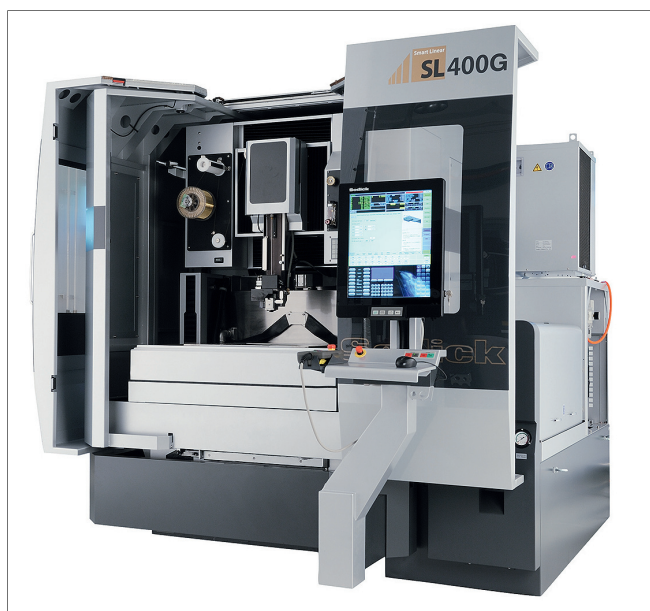
Wycinarka SL 400 G z otwartą przestrzenią roboczą – ułatwiony załadunek od góry
